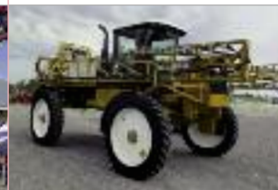
Arroseuse automotrice Ag-Chem 854 , 800 gal., 80 pi, 3 700 h
