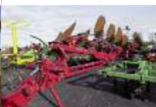
Charrue Grégoire Besson , 7 raies, réversible, déportable, déclencheurs hydraulique, sur 2 roues
