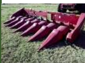
Nez à maïs Case 3408, 8 rangs, 2011, deck plate hydraulique
