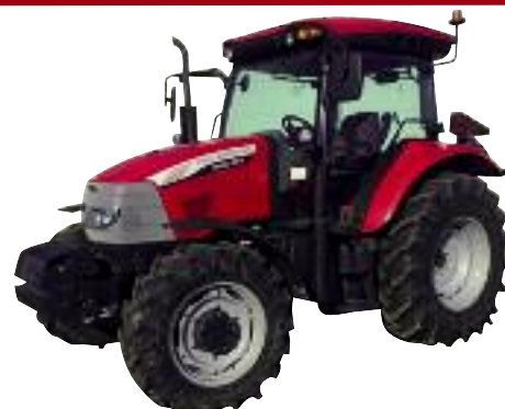
Tracteur McCormick X60-20, 92 hp, 2013, 4RM, 615 h, diesel, cab. a/c, transm. 36x12, inv. hyd., 3 sorties d'huile, pneus 18.4R30
