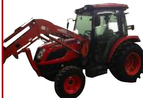
Tracteur Kioti NX6010, 2015, 60 hp, 600 h, cab. a/c, transm. hydrostatique, chargeur avant, 2 sorties d'huile, pneus industriels
