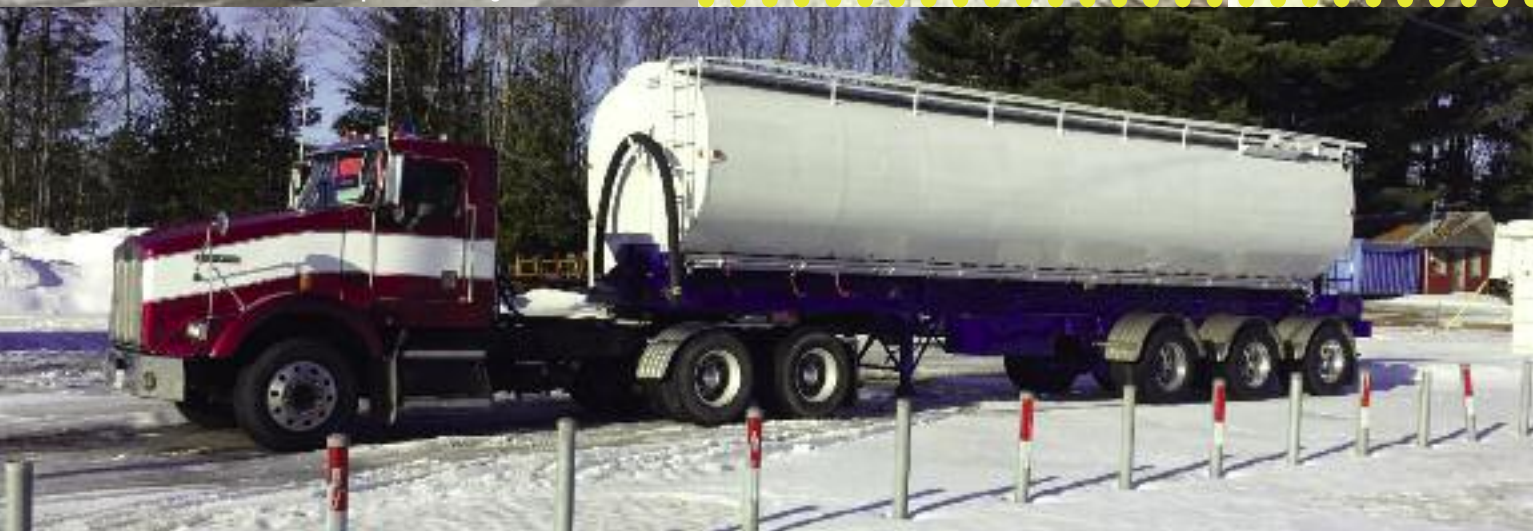
Camion 10 roues International avec boîte à moulée et système de soufflerie / aspirateur Walinga
