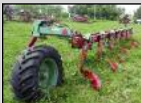
Charrue Kverneland 7BE8-115XP , 7 raies, semi portée, déclenchement automatique, roulette « plain » 22 po
