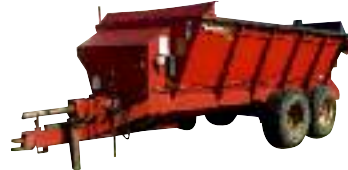
Épandeur Meyer Industrial 8720 , batteurs verticaux, PTO 1 000 tours, 23 000 $
