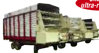
Boîte d'ensilage Dion , 19 pi, avec toit, décharge à gauche, côtés en acier et plancher recouvert de téflon, 9 000 $
