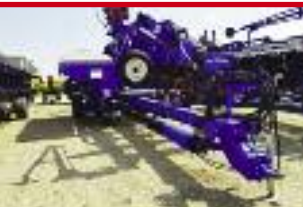
Planteur New Holland SP580, 12 rangs pivots, réservoir central, marqueur, tasses-résidus, no-till
