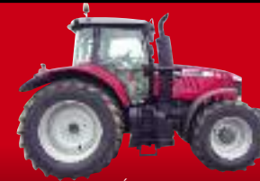
zz Tracteur MF 7 620, Édition Deluxe, 2013, 520 h, 4 sorties d'huile arrière électrique, CVT 50 km/h, full suspension, pneus 620/70R42
