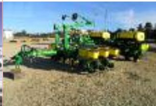
Planteur John Deere 1770 , 12 rangs, engrais liquide, disques no-till, z marqueurs, moniteur trak-350
